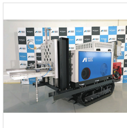
アネスト岩田とIOSが共同開発した地雷除去装置。先端のノズルから圧縮空気を噴射して安全に地雷を見つけ出す＝横浜市で
