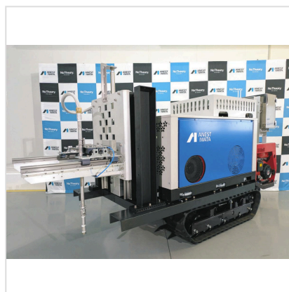
アネスト岩田とIOSが共同開発した地雷除去装置。先端のノズルから圧縮空気を噴射して安全に地雷を見つけ出す＝横浜市内
